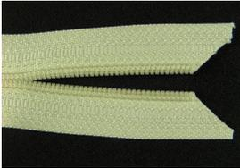
3. Schneiden Sie beide Seiten von der Mitte weg schräg in Richtung äußere Kante. Beachten Sie dabei, daß die Schnittkante der RV-Spirale scharf abgeschnitten und nicht ausgefranst ist. Ansonsten lässt sich der Schieber nicht ordentlich einfädeln.
